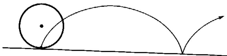
FIG. 1.185. Traiettoria reale di un punto situato alla periferia della ruota (cicloide)
