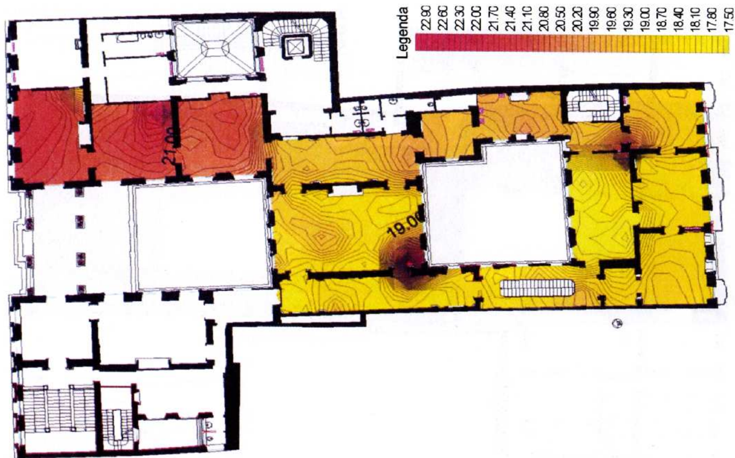
Immagine 12 – Palazzo Bagatti Valsecchi, Milano. Mappatura della temperatura dell'aria all'interno del primo piano rilevata alle ore 15 mediante l'utilizzo di psicrometro digitale.
