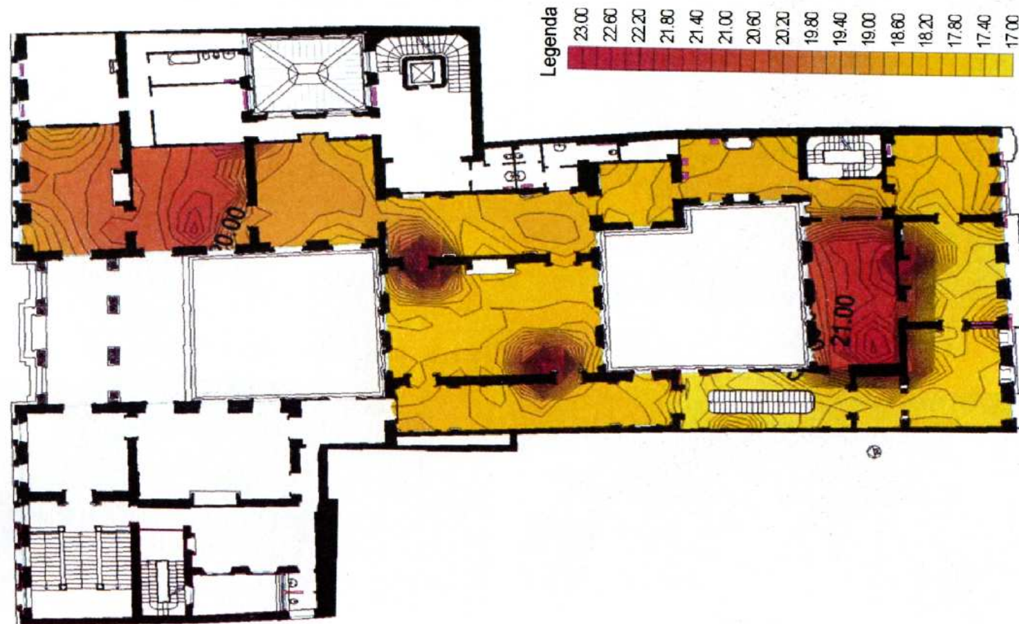
Immagine 11 – Palazzo Bagatti Valsecchi, Milano. Mappatura della temperatura dell'aria all'interno del primo piano rilevata alle ore 9,45, poco dopo l'accensione dell'impianto di riscaldamento, mediante l'utilizzo di psicrometro digitale.
