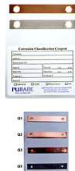
Fig. 3.5 Indicatore di processi di rischio ambientale di corrosione nei metalli chiamato CCC (corrosion classification coupons) distribuito dalla Purafil Inc. Sotto, una serie di provini dopo l'esposizione in atmosfera inquinata.
