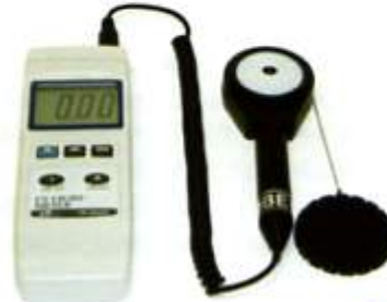
Fig. 4.19 Fotometro per la misura della radiazione ultravioletta.
