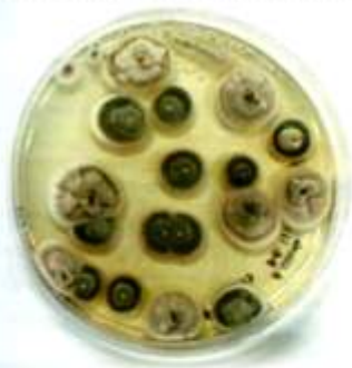
Fig 4.23 Crescita di colonie fungine sulla piastra con terreno di coltura utilizzata nel campionatore SAS.
