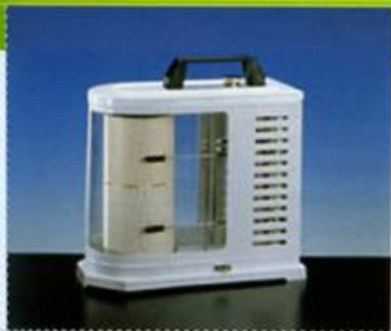
Fig. 4.8 Termoigrografo registratore su carta. È uno strumento meccanico con igrometro a capelli (UR) e termometro bimetallico. Due penne tracciano gli andamenti su un diagramma settimanale.
