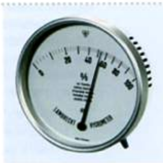
Fig. 4.4 Igrometro a capello Lambrecht affidabile e ancora in commercio.
