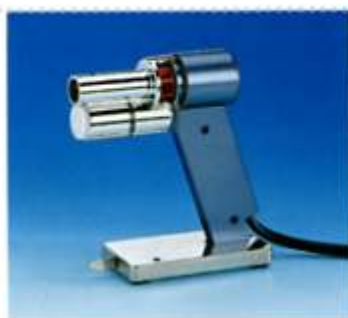
Fig. 4.3 Psicrometro elettronico da collegare a datalogger. Notare la presenza del serbatoio d'acqua (bianco) e l'aspiratore (rosso).
