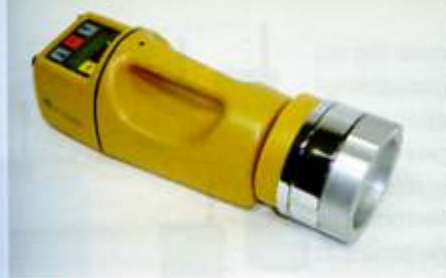
Fig 4.22 SAS, campionatore di particelle biologiche su terreno di coltura.
