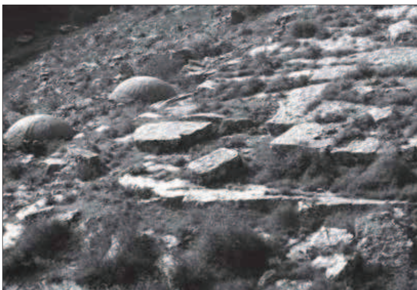
Fig. 93. - Jerguçat, blocchi di calcare in fase di distacco al fronte di cava.
