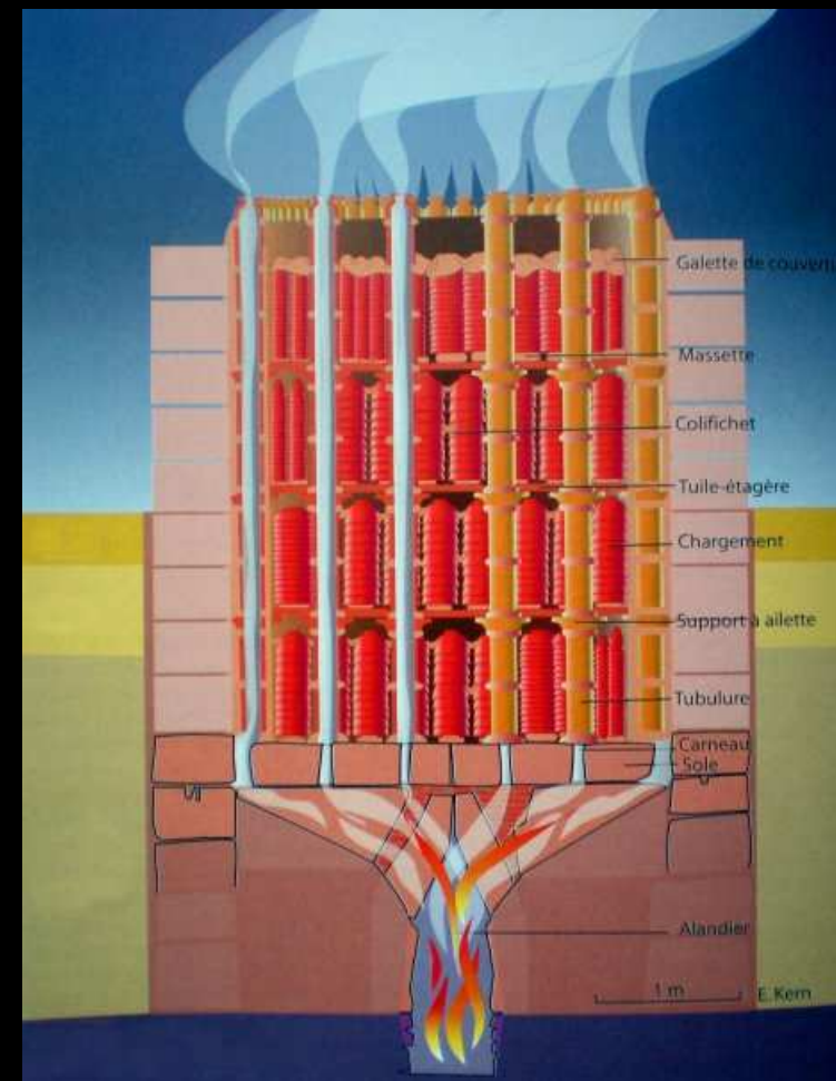
Schema di carico di una fornace di Sigillata Gallica degli ateliers di Dinsheim-Heiligenberg
