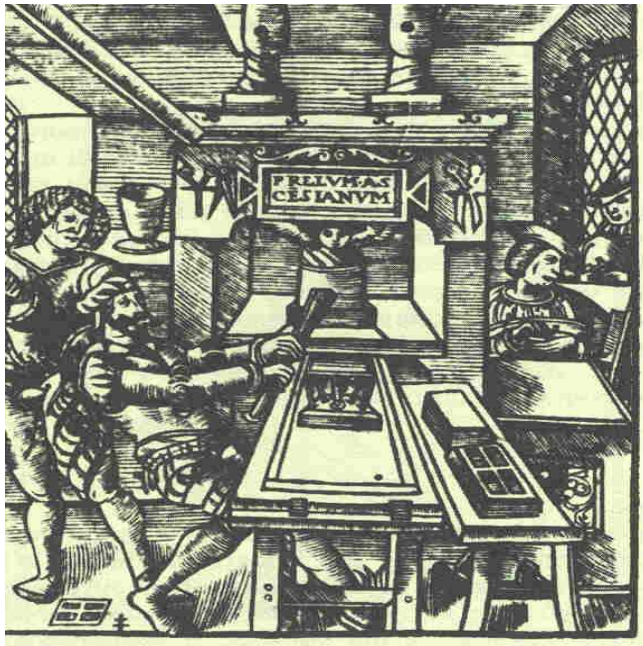
Il torchio in un'incisione cinquecentesca. Sono visibili i due montanti verticali e la vite senza fine.
